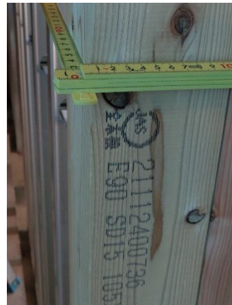
X2×Y4 通 柱 C3：JAS 機械等級構造用製材
