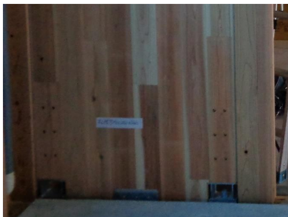
X1~2×Y4 通 壁 No.5： CLT 3層3プライ 杉 [下部] 引張、せん断金物
