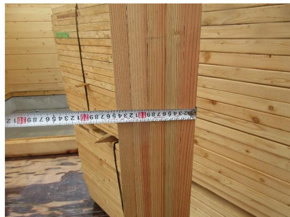
1階 X6~7×Y4~5 通 柱: JAS 構造用集成材 米松 せい 145
