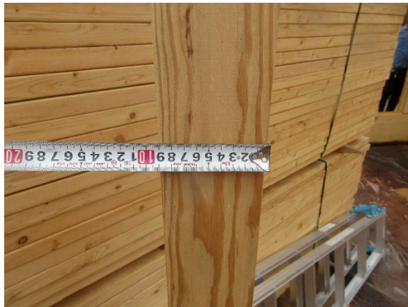
1階 X6~7×Y4~5 通 柱： JAS 構造用集成材 米松 巾90
