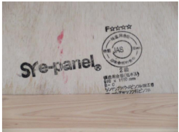
2 階床 JAS 構造用合板 (JAS 印) シンヤップ ライトウッド ビンツル(株)工場 マレーシア 認証年月日 平成 18 年 09 月 01 日 認証番号 JPIC-PW18
